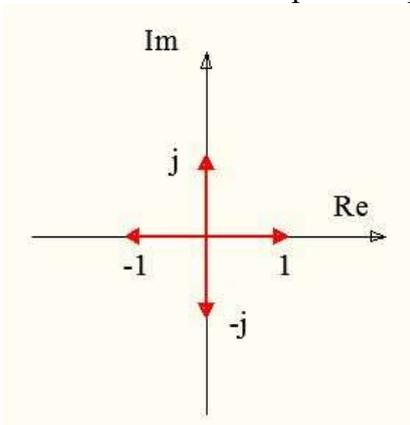
Il vettore di modulo 1 con sola parte reale ( quindi fase 0 ) sarà rappresentato sull'asse reale  $V = 1$
