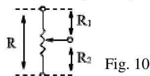
Dal punto di vista fisico potenziometri e trimmer si distinguono dal fatto che nel primo caso il movimento del cursore è possibile attraverso una leva di una certa dimensione che viene fatta ruotare sul suo asse (potenziometri **rotativi**) o che viene fatta scorrere longitudinalmente (potenziometri **a slitta**), mentre nel secondo caso le dimensioni sono più ridotte e il movimento del cursore è dato da un alberino rotante manovrabile solo tramite cacciavite.
