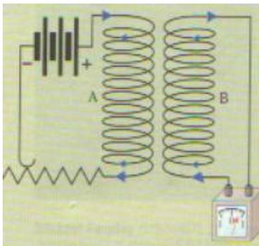
Si hanno a disposizione due bobine, una A con generatore (*circuito primario*), una B senza (*circuito secondario*), ma collegata ad un amperometro. Fra le due bobine non c'è contatto elettrico. Si può far circolare corrente (indotta) nel circuito secondario.
