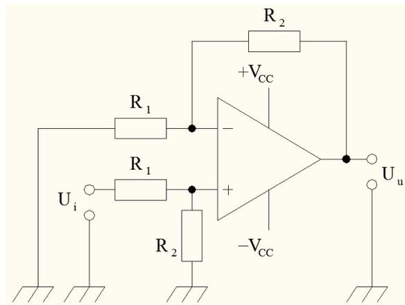
Applicando il teorema di Millman sugli ingressi invertente e non invertente che per il principio di cortocircuito virtuale sono allo stesso potenziale
