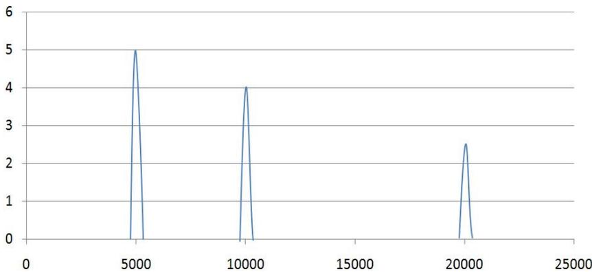
b) immagine sull'analizzatore di spettro per lo studio nel dominio della frequenza; Sull'analizzatore di spettro potremo osservare la frequenza e l'ampiezza di ogni segnale semplice che compone il segnale complesso.
