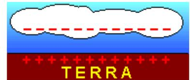
Se la differenza di potenziale tra nuvola e terra supera un valore compreso tra gli 80 milioni e il miliardo di volt, l'aria viene perforata dalle cariche elettriche e si ha il fulmine, con una corrente che ha un valore medio di 10000 ampere e un valore limite pari a 200000 ampere. Un fulmine potrebbe alimentare una lampada da 100 Watt per tre mesi.
