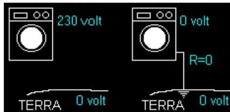
In figura vediamo che se una lavatrice soggetta a guasto è collegata a terra, il suo potenziale rimane a zero. In realtà **il collegamento a terra non è mai a resistenza zero**, in quanto qualsiasi conduttore elettrico possiede una certa *resistenza*. Si fa in modo che questa sia la più bassa possibile, avvicinandosi così al caso ideale.
