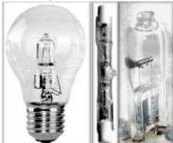
Sono anch'esse **lampade ad incandescenza** e quindi sfruttano lo stesso principio. Nel bulbo sono introdotte piccole quantità di alogeno che danno luogo a un processo che riporta sul filamento il tungsteno volatilizzato.
